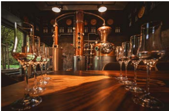
Srdcom Myjavskej pálenice je celomedená destilačná kolóna Arnold Holstein s objemom kotla 300 litrov.
